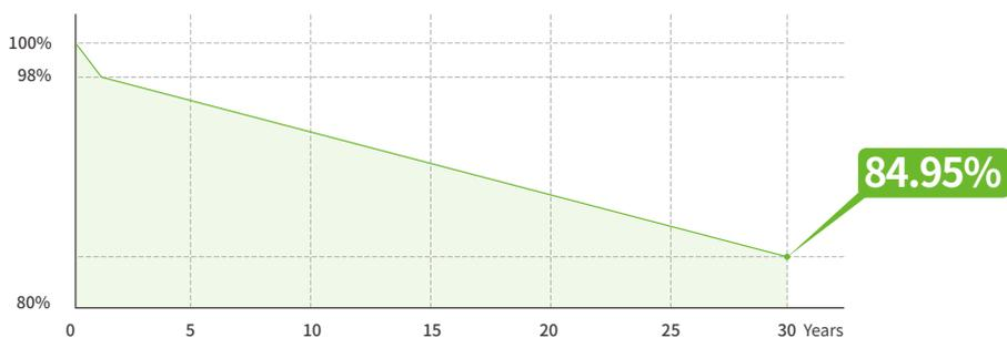
3) N型单玻&双玻组件在质保起始日起1年内,在标准测试条件(标准测试条件STC:AM1.5,光辐照强度1000W/m<sup>2</sup>,电池温度25°C)下输出功率不低于其产品规格书或者产品铭牌上标明的STC额定峰值功率的99%;接下来的第2到30年,组件在标准测试条件下输出功率与其产品规格书或者产品铭牌上标明的STC额定峰值功率相比每年下降不超过0.4%。因此,组件从质保起始日起第30年内,在标准测试条件下功率输出值不低于其产品规格书或者产品铭牌上标明的STC额定峰值功率的87.4%。
