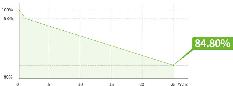
2) P型双玻组件在质保起始日起1年内,在标准测试条件(标准测试条件STC:AM1.5,光辐照强度 $1000\text{W}/\text{m}^2$ ,电池温度 $25^\circ\text{C}$ )下输出功率不低于其产品规格书或者产品铭牌上标明的STC额定峰值功率的98%;接下来的第2到30年,其组件在标准测试条件下输出功率与其产品规格书或者产品铭牌上标明的STC额定峰值功率相比每年下降不超过0.45%。因此,组件从质保起始日起第30年内,在标准测试条件下功率输出值不低于其产品规格书或者产品铭牌上标明的STC额定峰值功率的84.95%。
